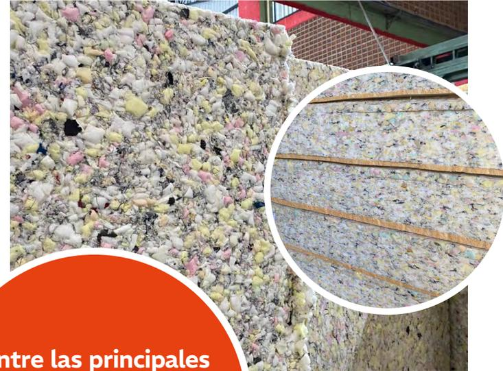
Entre las principales acciones, se realizó la clasificación de los subproductos en los sectores (telas y espumas).
